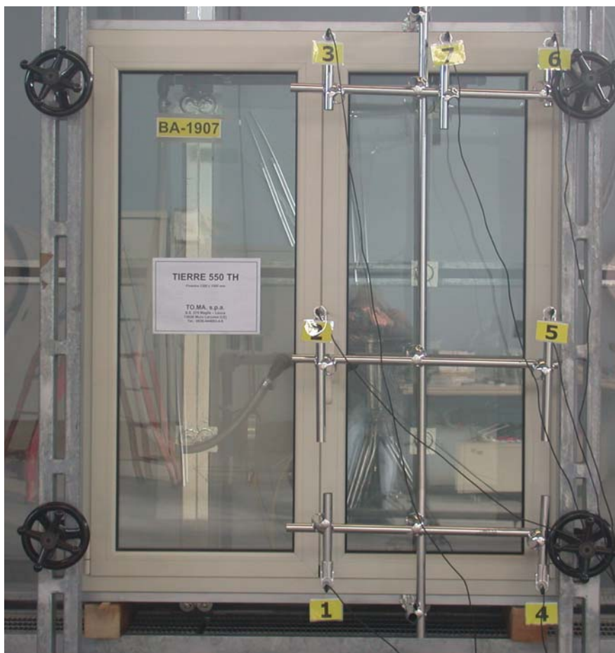
Foto 2: Campione sottoposto a prova durante i test di resistenza al vento (prova di deformazione)
